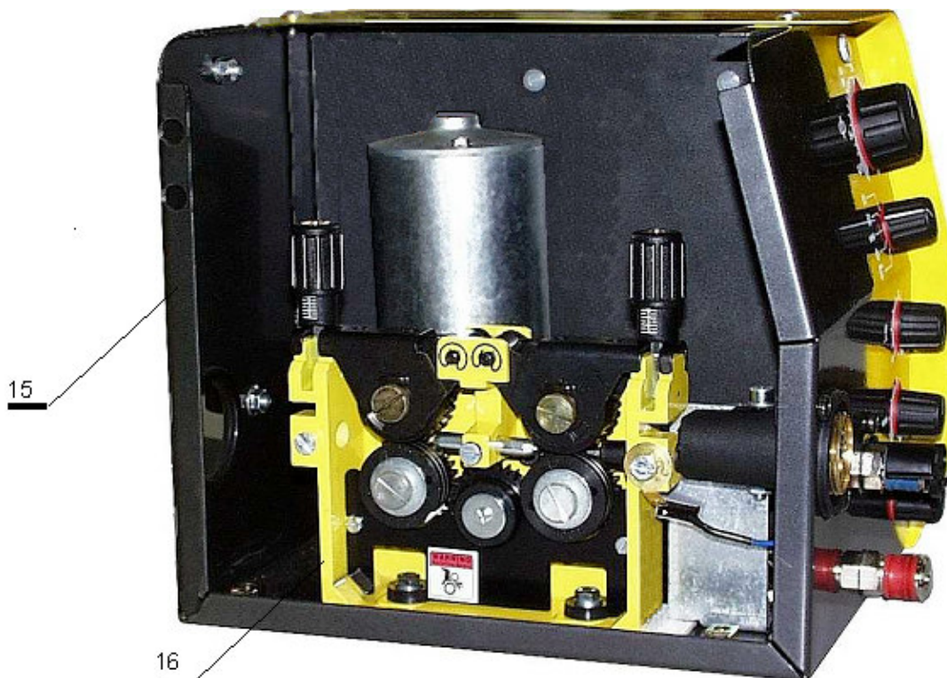
Rys. 3. Zespół podający Origo™ Feed 30w. Widok kasety po otwarciu osłony zespołu napędowego.
